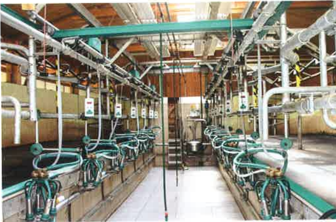
2 x 6 Fischgrät-Melkstand, die Grube ist eben begebar.
